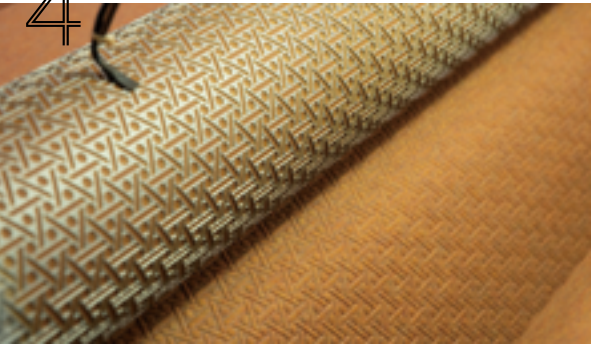
步驟四 Step 4 進行 3D 熱壓工序，製作獨特的紋理。 The fabric goes through 3D sublimation to obtain unique textures.
